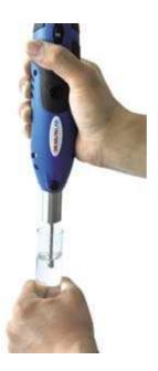
L'agitateur à tige à main de tissus rotor/stator D160 à main capable de rapidement disperser, homogénéiser, extraire, dissocier les cellules, mélanger, émulsionner, suspendre des échantillons dans des liquides de 0,1 à 5 ml ou de 1 à 250 ml selon l'arbre de dispersion. Pendant le fonctionnement, les matières en suspension sont aspirées dans le cœur de l'homogénéisateur par un rotor tournant à 30 000 tr/min.
